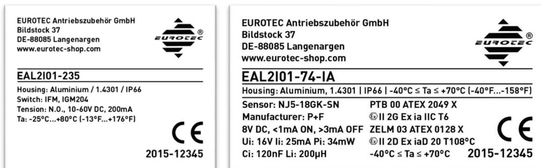
Abb. 1: Kennzeichnung (ohne und mit eigensicheren Sensoren)
