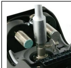
Abb. 5: Mutter lösen
