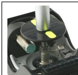
Abb. 5: Anzeige entfernen
