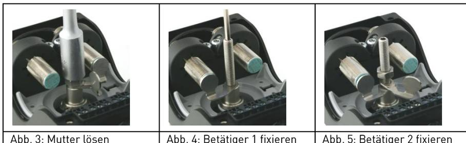
Abb. 3: Mutter lösen
